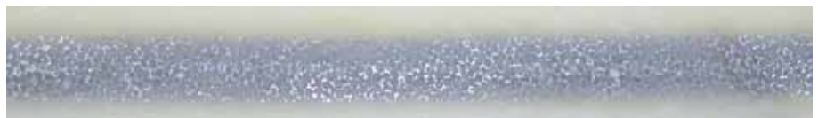
Offenporiges Lauramid Hybrid®: Lauramid® durchdringt den Aluminiumschaum komplett
