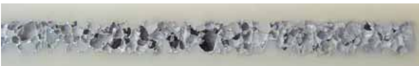
Geschlossenporiges Lauramid Hybrid®: Lauramid® dringt in die äußeren Poren des Aluminiumschaums ein
