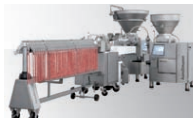
Producción continua de salchichas con el sistema ConPro 200
