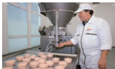
Dosatura automatica in contenitori
