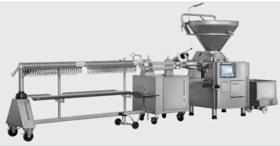
↑ Линия набивки сосисок PLH 216 с навешивающим устройством AHE 242
