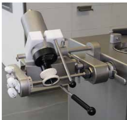
↑ Устройство для вытягивания оболочек 78-6
