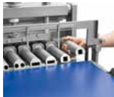
↑ Remplacement tube de formage
