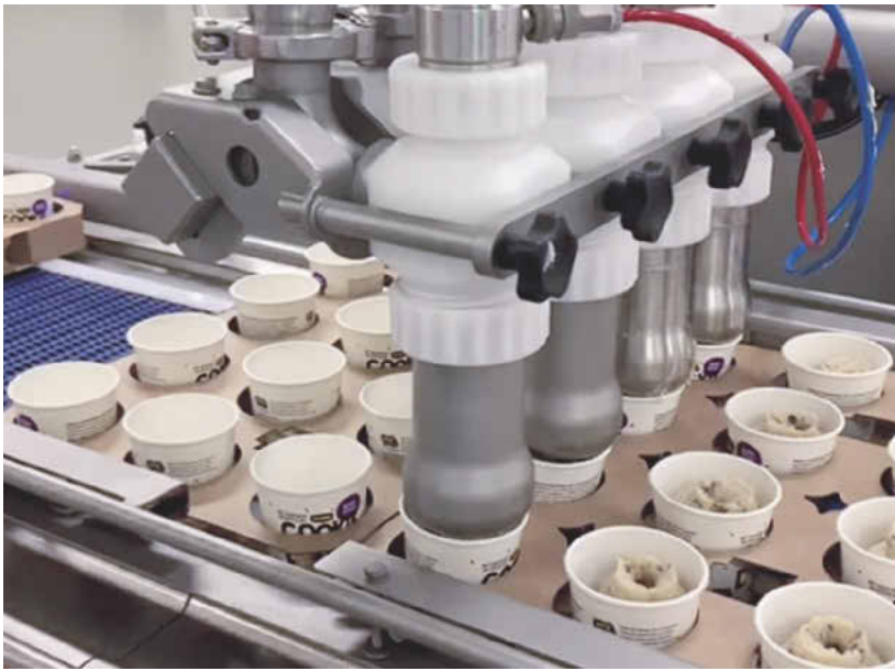
Vierbahnige Dosierung von Cookie Teig mithilfe des vollautomatischen Dosiersystems VDM
