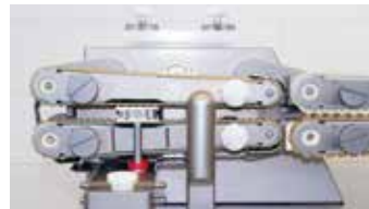
↑ Разделительное устройство с разделительным модулем
