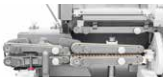
← Линкерная система обеспечения заданной длины порций с вытеснителем
