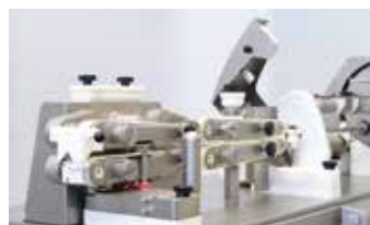
↑ exaktes Trennen mit 2-Band-Lösung und Sensor
