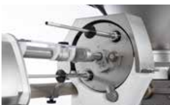
↑ Carga de tripa con función de cambio de tripa semiautomática
