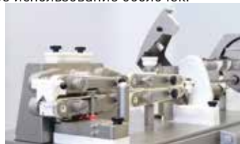
↑ Точное разделение с использованием двух транспортеров и датчика
