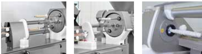
↑ Вытягивание оболочки с полуавтоматической функцией смены оболочки
