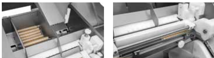
↑ Накопитель для колбасных оболочек и направляющую для автоматического вытягивания оболочки
