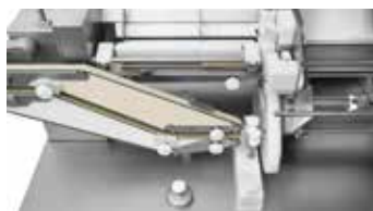
← Линкерная система обеспечения заданной длины порций
