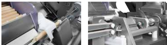
↑ Dispenser di involucri con arricciatura automatica del budello degli stick di budello
