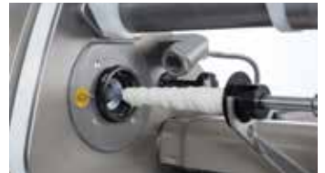
↑ Оптический датчик распознавания конца оболочки
