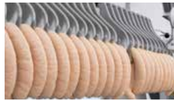
↑ Передача на навешивающее устройство
