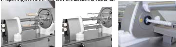
↑ Вытягивание оболочки с полуавтоматической функцией смены оболочки
