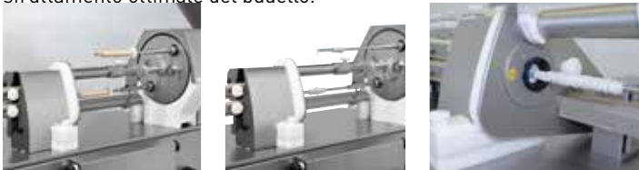
↑ Arricciatura del budello con funzione semi-automatica di cambio budello
