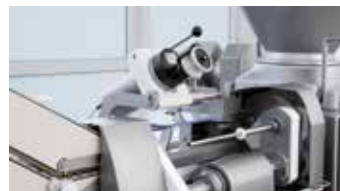
↑ Устройство для вытягивания оболочек DA 78-6
