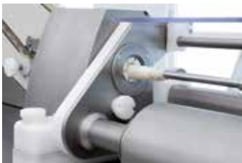
↑ Enfilage de boyau avec fonction de changement de boyau semi-automatique
