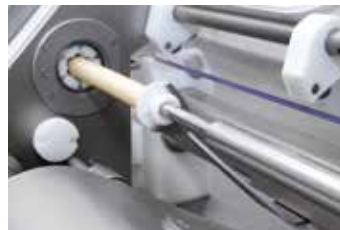
↑ Enfilage de boyau avec fonction de changement de boyau semi-automatique
