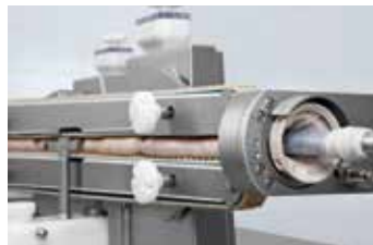
↑ Inserção de tripas com braço torcedor e bico de torcimento
