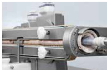
↑ Enfilage de boyaux avec main automatique et cornet de fermeture
