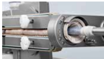
↑ Caricamento del budello con mano automatica e tubo di attorcigliatura
