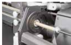
↑ Inserção automática de tripa celulósica e de colágeno
