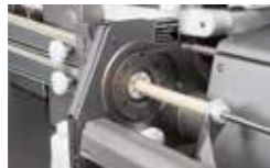
↑ Enfilage automatique de boyau artificiel et à base de collagène
