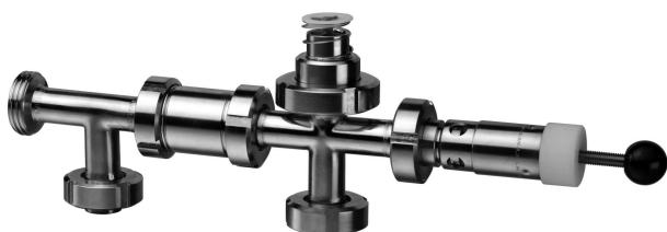
Tanks oder Behälter sind oft mit einer kombinierten CIP/Gas-Tankleitung ausgestattet. Diese endet auf dem Tank in einer Reinigungs-Luft-Ventilkombination (RLV-Kombination), die über zwei Tankanschlüsse verfügt. Diese kompakte Multi-Funktionseinheit steuert über ein integriertes Umschaltventil die Zuleitung der CIP-Flüssigkeiten oder die Zu- und Ableitung der Gasströme / CO<sub>2</sub>. So ist ein sicheres Medienmanagement gewährleistet.
