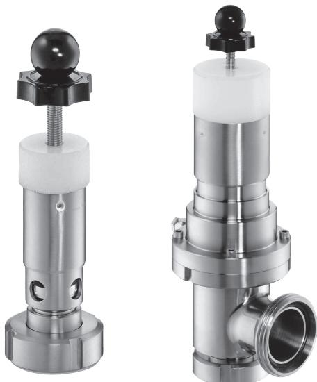
Diese kostengünstige Typenreihe ist äußerlich durch das zylindrische Gehäuse erkennbar. Einsetzbar sind diese Sicherheitsventile in vertikaler oder horizontaler Lage, speziell geeignet sind sie zur Druckabsicherung kleinerer Behältnisse.
