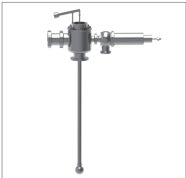
Tanks oder Behälter sind oft mit einer kombinierten CIP/Gas-Tankleitung ausgestattet. Diese endet auf dem Tank in einer Reinigungs-Luft-Ventilkombination (RLV-Kombination), die über einen Tankanschluss verfügt. Diese kompakte Multi-Funktionseinheit steuert über ein integriertes Umschaltventil die Zuleitung der CIP-Flüssigkeiten oder die Zu- und Ableitung der Gasströme / CO<sub>2</sub>. So ist ein sicheres Medienmanagement gewährleistet.
