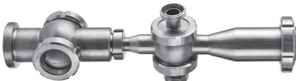
Die VARIOair Belüftungsarmatur findet vorwiegend Verwendung bei der Hefe- und Würzebelüftung in Brauereien. Der gelöste Sauerstoff beschleunigt das Hefewachstum bzw. daraus resultierend später in der Gärphase den Zuckerabbau und die Alkoholbildung. Auch in anderen Industriezweigen kann die Armatur als Belüftungseinheit eingesetzt werden.
