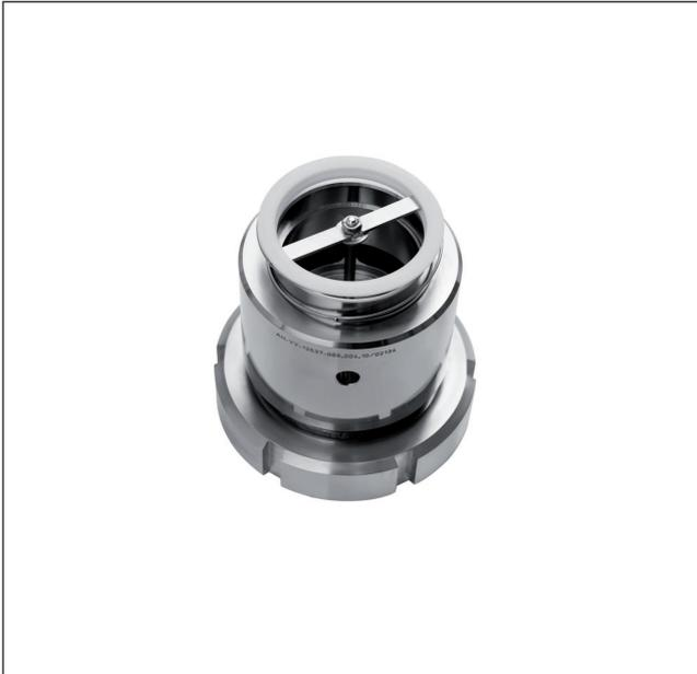
Diese Ventiltypen sind zur Unterdruckabsicherung von kleineren und mittleren Behältern konzipiert. Sie können als Einzelventil oder in Kombination mit einer Reinigungseinheit (RLV) verbaut werden. Einsetzbar sind diese Vakuumventile in stehender Baulage (vertikal) bzw. die federbelastete Ausführung auch in horizontaler Lage.
