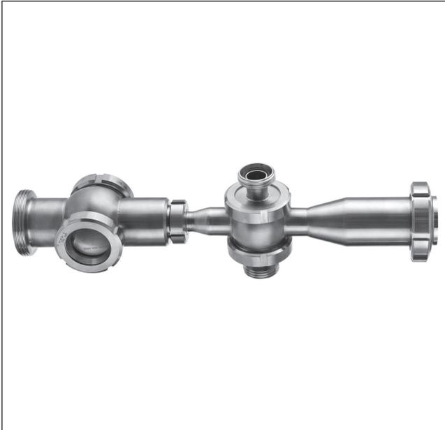
Die VARIOair Belüftungsarmatur findet vorwiegend Verwendung bei der Hefe- und Würzebelüftung in Brauereien. Der gelöste Sauerstoff beschleunigt das Hefewachstum bzw. daraus resultierend später in der Gärphase den Zuckerabbau und die Alkoholbildung. Auch in anderen Industriezweigen kann die Armatur als Belüftungseinheit eingesetzt werden.
