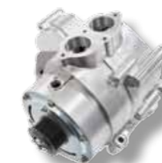
LU Bypassventil für 4-Zylinder Dieselmotor zur Verringerung der Schadstoffemissionen. Das Ventil steuert zugeführtes Abgas durch den Abgaswärmetauscher oder alternativ durch eine Bypassleitung.
